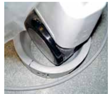
▲ Ειδικός προστατευτικός δακτύλιος για τα τροχήλατα - ακτινοσκοπικά, ώστε να μην φρενάρουν από τα καλώδια κατά την κίνησή τους.
