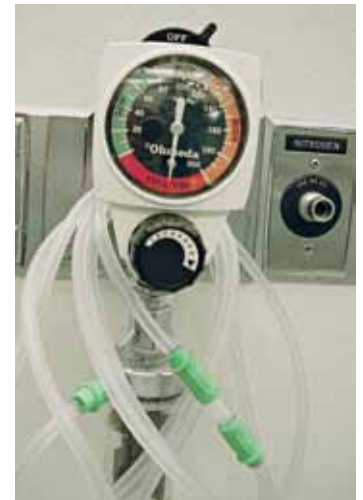
▲ Ειδικό εξάρτημα για ρύθμιση της έντασης της αναρρόφησης με μετρητή.
